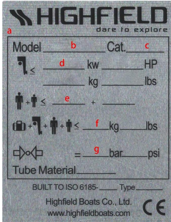
L'altération de la coque ou des accessoires permanents peut invalider les caractéristiques figurant sur cette plaque.
