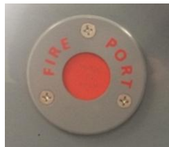
Feuerlöschöffnung auf der Backbordseite der Konsole
